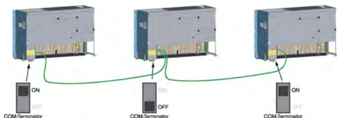
Abb. 19: FSL-CONTROL II Kommunikation 3 Geräte
