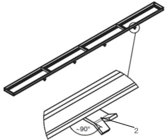
3) Die Querstreben werden nach dem Einmauern entfernt. Sie dienen der Stabilität des Mauerrahmens während dem Einmauern.
