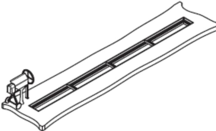
5) Entfernen der Querstreben (nach dem Aushärten des Beton)
