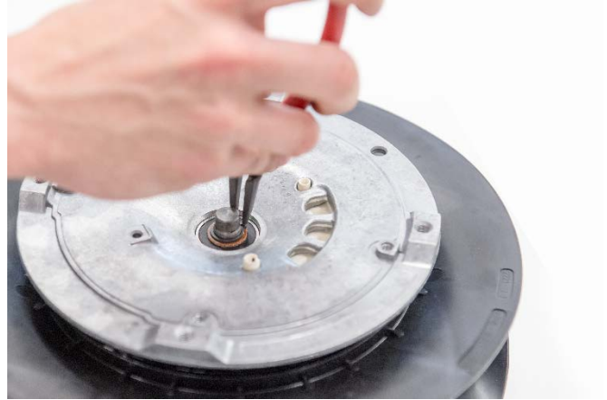
11. Nehmen Sie den Sicherungsring mit einer Sicherungsringzange ab.
